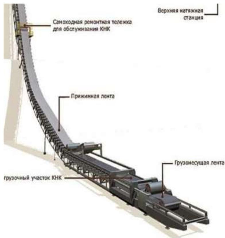
Рисунок 3. Крутонаклонный конвейер
