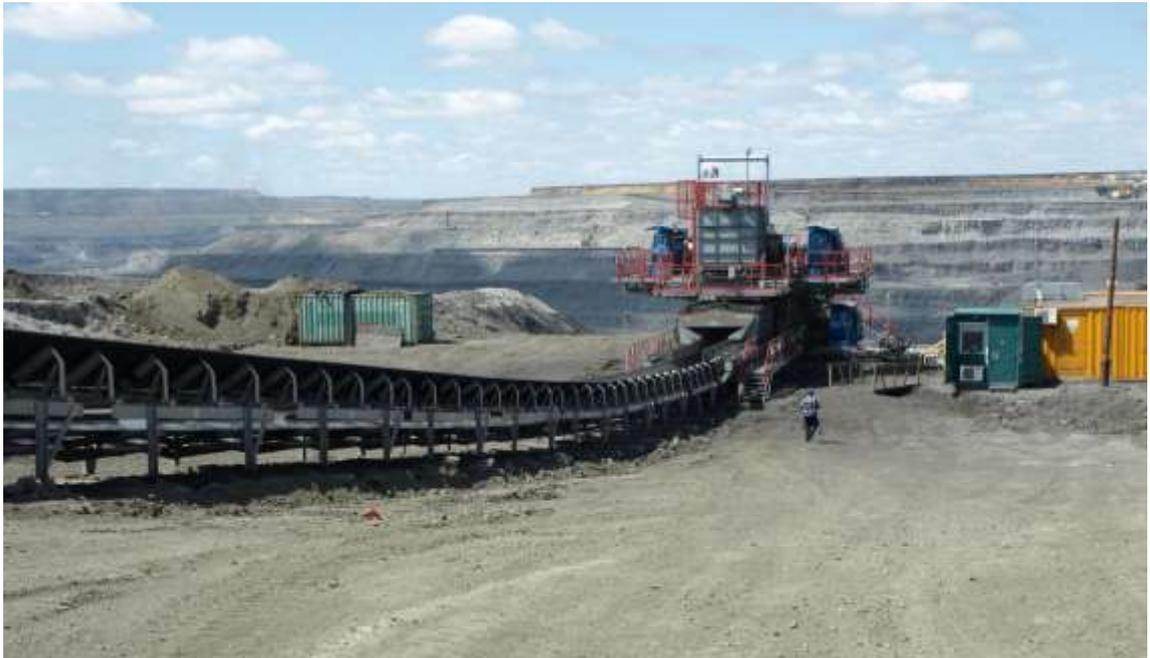
Рисунок 15- Конвейерный подъемник на вскрышных работах разреза «Восточный»
